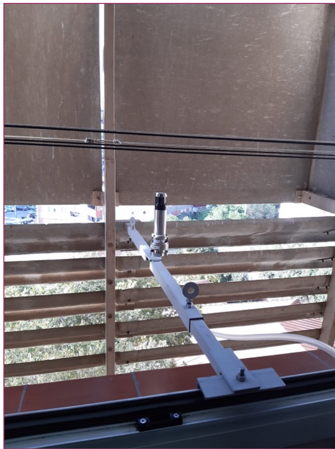
Exemple de mostreig a diferents alçades (interior de galeries) Ejemplo de muestreo a distintas alturas (interior de galerías) Ex.d'échantillonnage à différentes hauteurs (intérieur des galeries)
